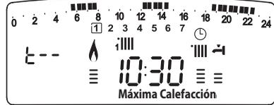
Para seleccionar el funcionamiento a la máxima potencia del circuito sanitario gire el encoder, en el display aparece:
